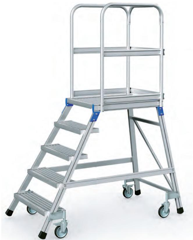
Die flexible Zugangslösung mit Gitterrost-Stufen für höhere Rutsicherheit bei Feuchtraumeinsätzen. Einfache und schnelle Montage aufgrund neuer Verbindungselemente. Mobil und schnell einsatzbereit aufgrund von vier Federlenkrollen (davon zwei mit Feststeller). Maximale Sicherheit durch dreiseitiges Plattformgeländer mit 1,00 m Höhe.
