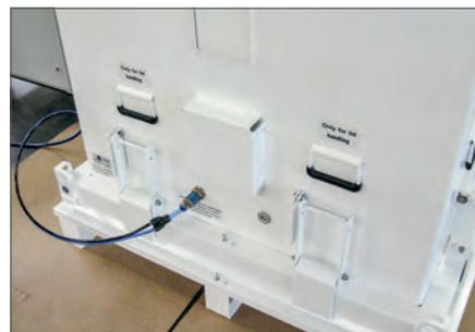
Wasserdampfdichter Behälter bei Dichtheitsprüfung durch Überdruck
