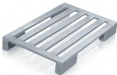
Hygienische Palette, robust und rollenbahngängig. Rahmen und Längssprossen aus geschlossenen, hochfesten und korrosionsbeständigen Aluminium-Profilen. Extra lange Eckfüße (L = 300 mm) vereinigen die Vorteile von Kufenunterbau und Eckfüßen. Sie sind z.B. rollenbahngängig und geeignet für Hochregallager. Großer Freiraum für Gabelzinken-Einfahrt. Keine störenden, durchgehenden Kufe, daher geringere Beschädigungsgefahr. Nahtstellen wasserdicht verschweißt.
