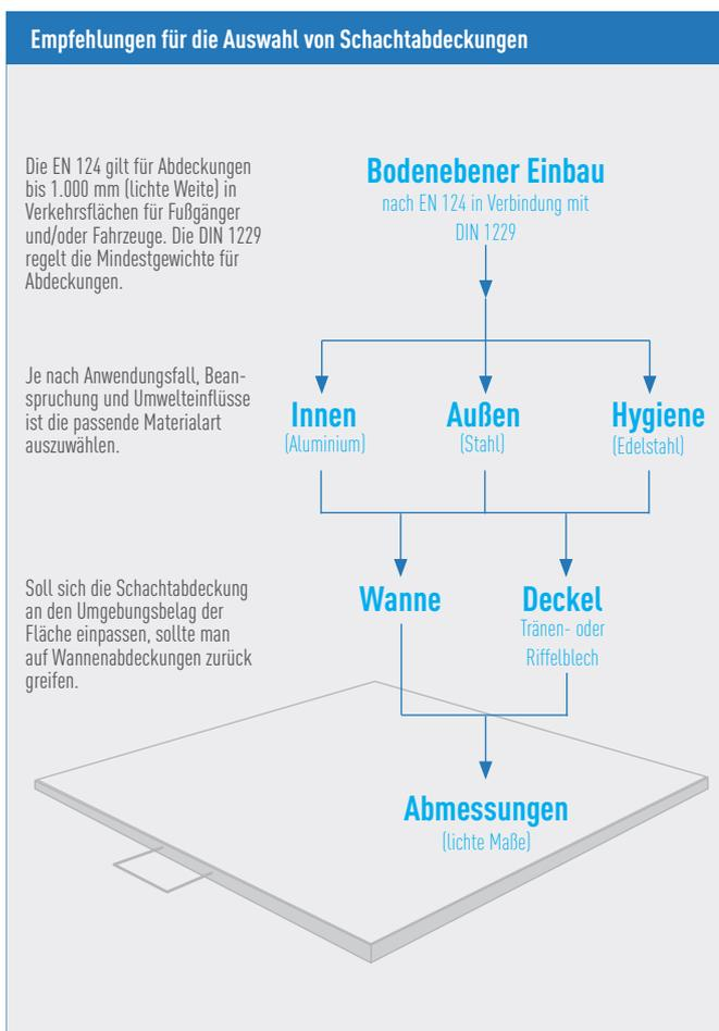
**Begeh- oder befahrbare Schachtabdeckungen mit wählbarer Oberfläche oder Deckelplatte für den Innen- und Außenbereich.**
