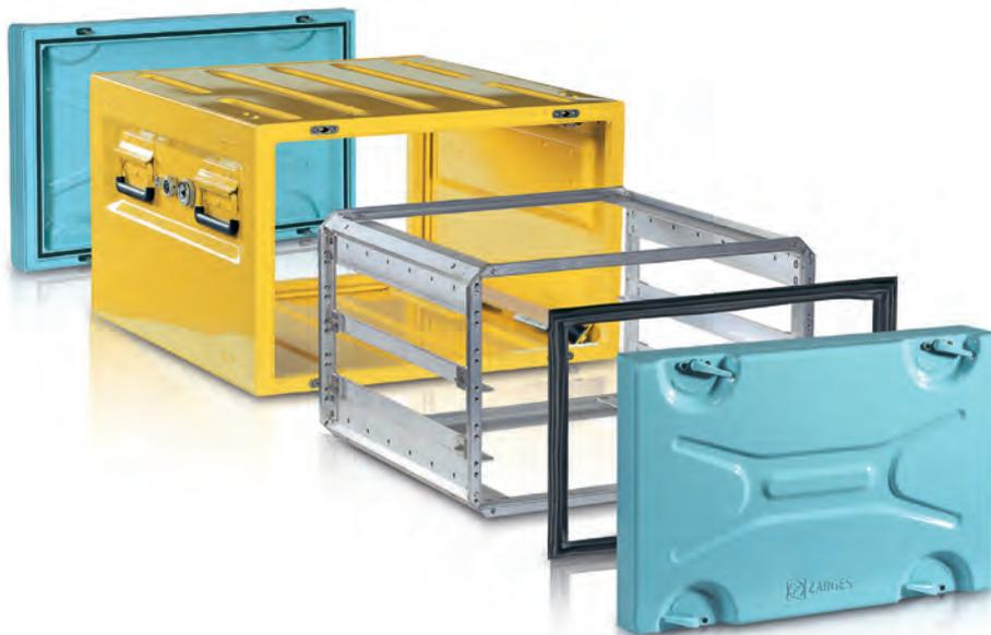
Mitraset® 19"-Gehäuse aus Aluminium sind für die Aufnahme von Elektronik-Geräten im 19"-Raster gemäß EN 60297-3-100 sowie EIA-310-E konzipiert. Die zu schützenden Elektronikgeräte werden in den elastisch aufgehängten Schwingrahmen eingesetzt und verschraubt und sind so optimal geschützt.
