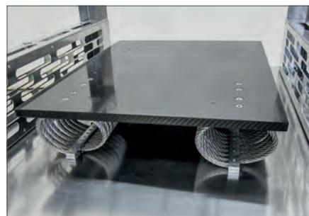
Aufnahmetisch, schwingend gelagert mit Gummipuffer oder Drahtseildämpfer
