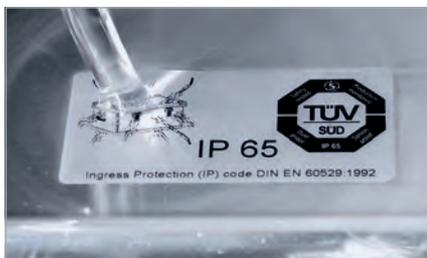
Strahlwasserschutz nach Norm IP 65
